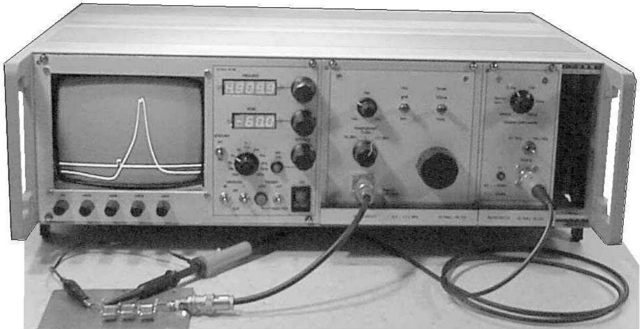
Bild 4 Meßaufbau (Durchlaßkurve eines Quarzfilters)
