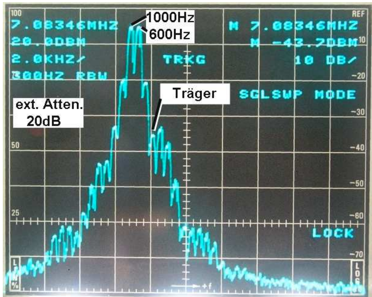
Foto 16 Sender moduliert mit Zweitonsignal 1000/600Hz
