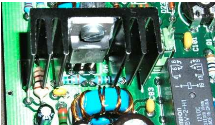
Foto 4 Hauptplatine – Detailansichten der Endstufe
