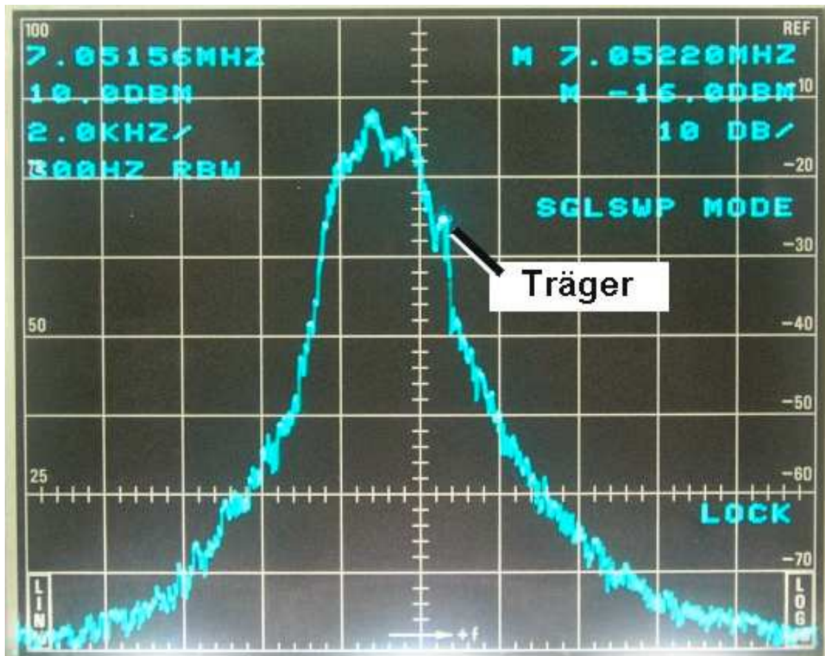
Foto 14 Sender moduliert mit NF-Rauschen
